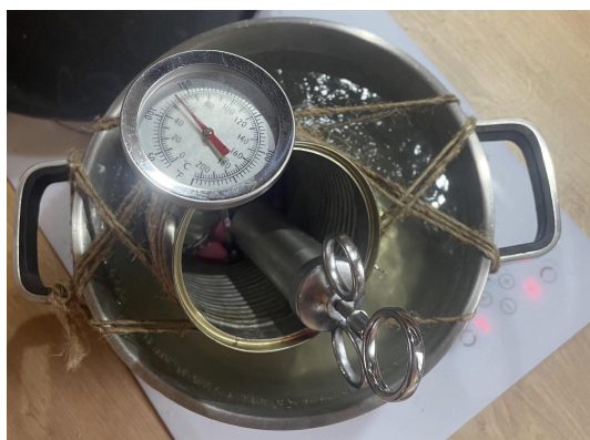
joonis 7: marinaadi süstal plekkpurgis koos sulavaha ja vahatermomeetriga. Plekkpurk on seotud takunõõriga poti külge ja vesi potis tagab vaha ühtlase soojenemise purgis.
