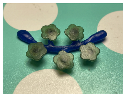
joonis 4: lõikuriga lõigatud õitega esmane vahamudel
