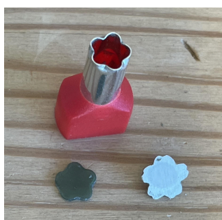
joonis 3: käsitsi saetud hõbeplekist õis ja lõikuriga lõigatud vahast õis
