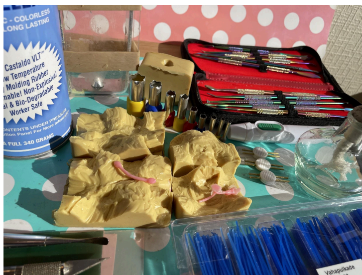
joonis 6: lahtised silikoonkummist vormid koos vahast süstitud detailidega, patareidega töötav vahanuga erinevate otsikutega, piirituslamp, lillekujulised lõikurid pehmetele materialidele, vakstu puhta vahatöö tagamiseks, voolimispulgad ja skalpell, castaldo aerosool vahadetailide vormist eemaldamiseks, castaldo silikoonkummist vormi valmistamise komplekt, rohelist, roosat ja sinist vahamaterjali lehe ja pulga kujul.
