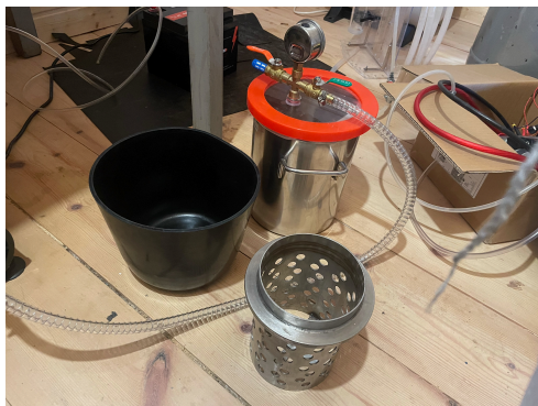
joonis 11: kummist segamise nõu, vaakumkamber ja perforeeritud roostevabast terasest silinder
