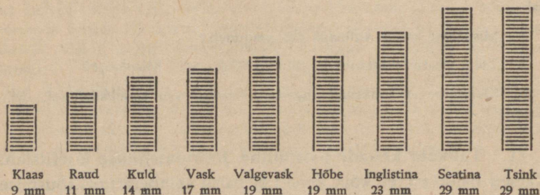
104. joon. 10-meetrise varva paisumine soojendamisel 100° võrra.
