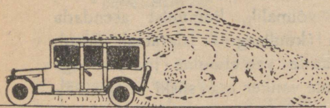
26. joon. Auto liikumisel tekkinud õhukeerised takistavad liikumist.
