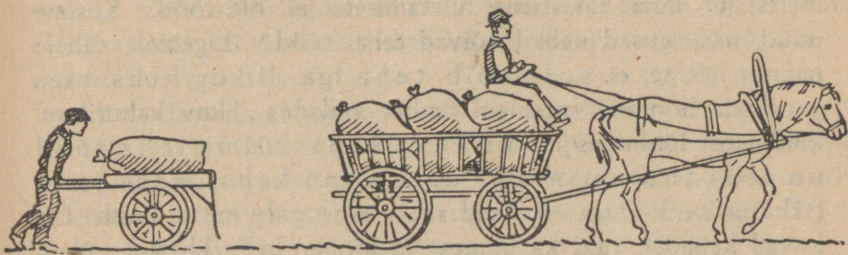
52. joon. Hobuse tõmbetugevuse mõõtmine koorma vedamisel.
