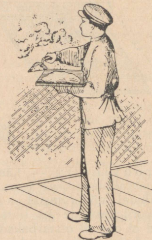
Joon. 53. Krohvi pealekandmine (viskamine) paletilt
