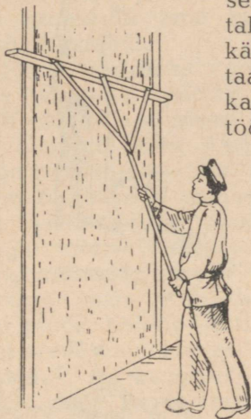
Joon. 59. Mördikihi tasandamine pikavarrelise rihtlatti abil
