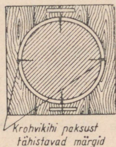
Joon. 109. Šablooni paigaldamine rõngasmajakate tegemiseks siledale sambale
