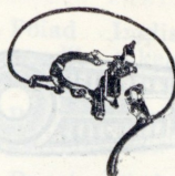
Nr. 248. Pidurid „Bowden“, esim. ratta pöia peale pidurdav.
