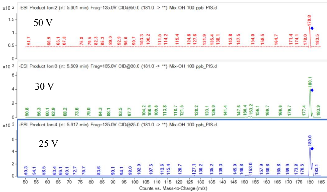
Joonis 16. 2-OH-Flu üleminekud 25 V, 40 V, 50 V ja 60 V põrkeenergiate juures -ESI produktiooni režiimis
