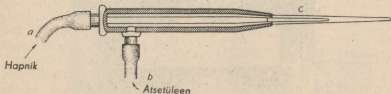
Joon. 18. Atsetüleeni-hapnikupõleti skeem:
