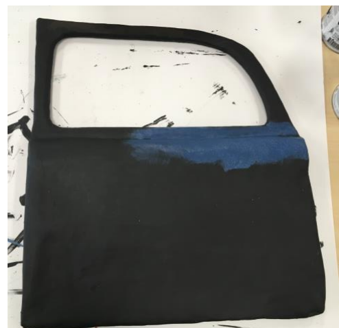
Mustaks krunditud uks, ootab sinisega katmist
