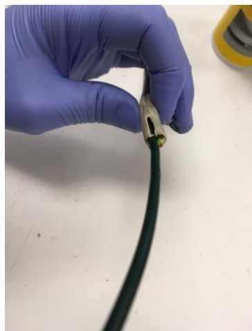
Ukselingi valmistamine elektrikaablist.
