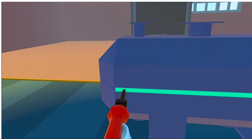
Joonis 11. Keevitusjoone indikaator ja keevitusmasin.
