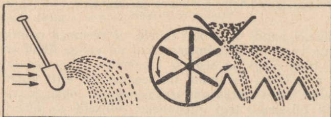
Joon. 137. Tuulamis- ja sorteerimismasina töötamise põhimõte.
