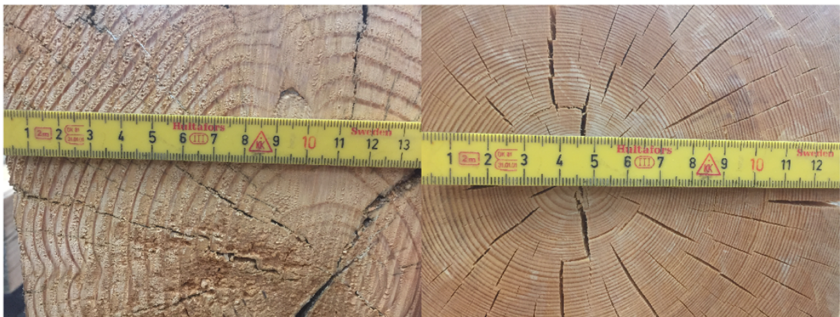
Joonis 16. Olenevalt kasvutingimustest võib aastarõngaste tihedus olla sama puuliigi lõikes väga erinev (Foto: Andres Veel)
