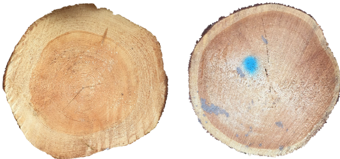
Joonis 15. Erineva malts- ja lülipuidu osakaaluga männipalgid (Foto: Andres Veel)
