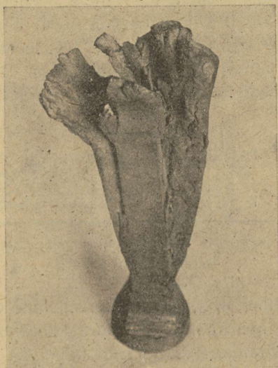
Joon. 45. Väävlirikas teras pärast sepistamist.
