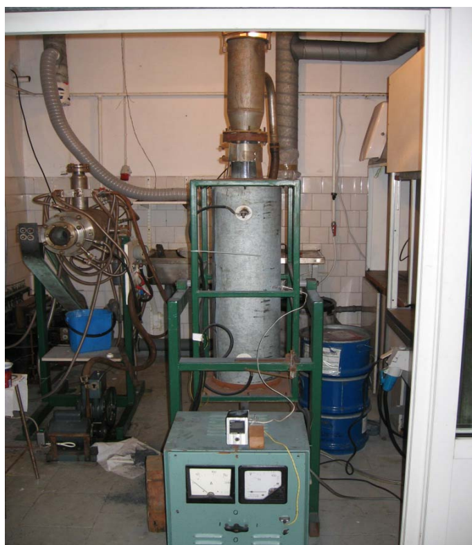
Joonis 10. Keevkihi reaktor Tartu Tehnoloogiad OÜ-s.
