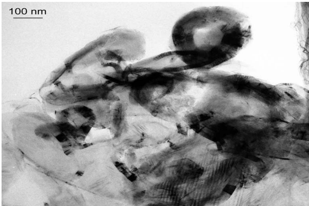
Joonis 5. Turbostraatse struktuuriga süsinikmaterjal.
