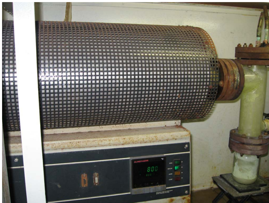
Joonis 8. Statsionaarkihi reaktor Tartu Tehnoliigid OÜ-s.
