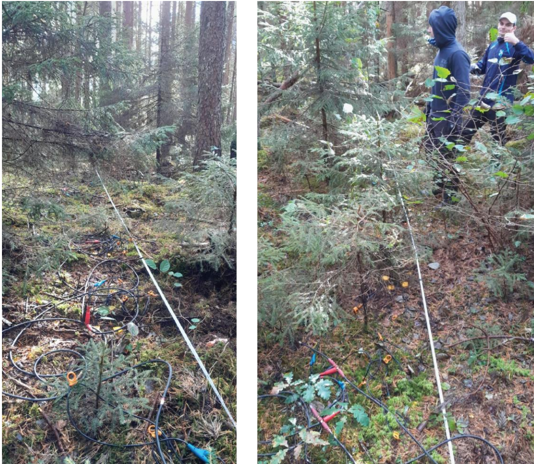
Pilt 1. Geofonide paigutus välitöödel (Foto: Argo Jõelett)
