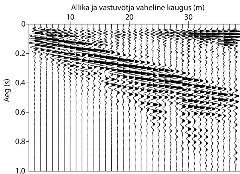
Joonis 13. Seismogrammid pikett 13+000 juures näitavad hästi välja kujunenud pinnalaineid.
