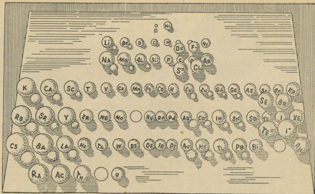
Joon. 4. Aatomite ja ionide suhtelised suurused. Selles tabelis on näidatud tänapäeval teadaolevad aatomite ja ionide suurused. Mõnede elementide kohta on meil teada nii ionide kui ka aatomite raadiused. Neil juhtudel on Mendelejevi tabeli igas ruudukeses näidatud kaks kuulikest. Negatiivsed ioonid on aatomeist suuremad; positiivsed ioonid on aatomeist väiksemad,
