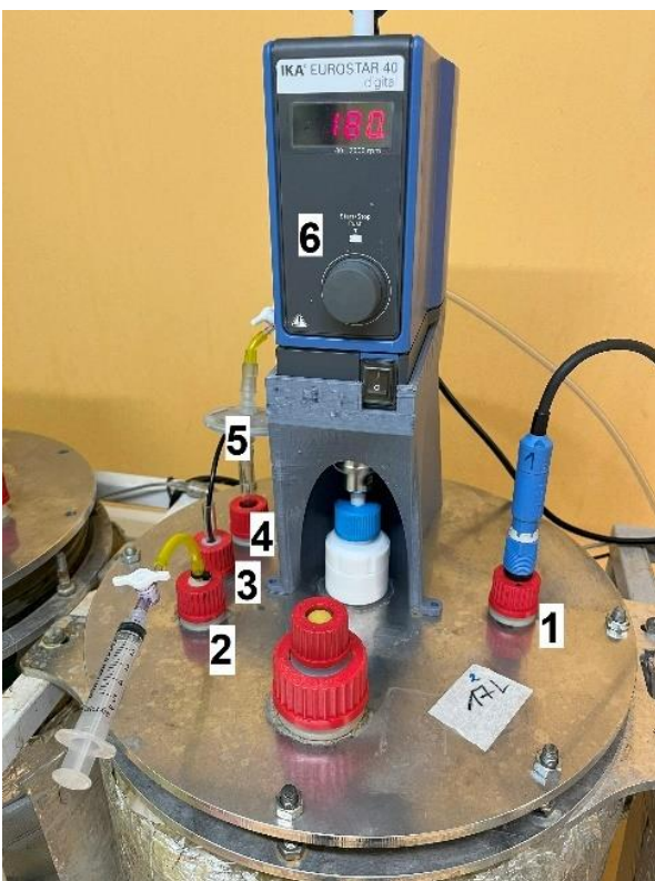
Joonis 14. Töövalmis BiotaTec 20-liitrine bioreaktor. Bioreaktoriga on ühendatud pH andur (1), proovivõtutoru (2), temperatuuriandur (3), aeratsiooni ava (4), aeraator (5), segaja (6), jahuti (7).
