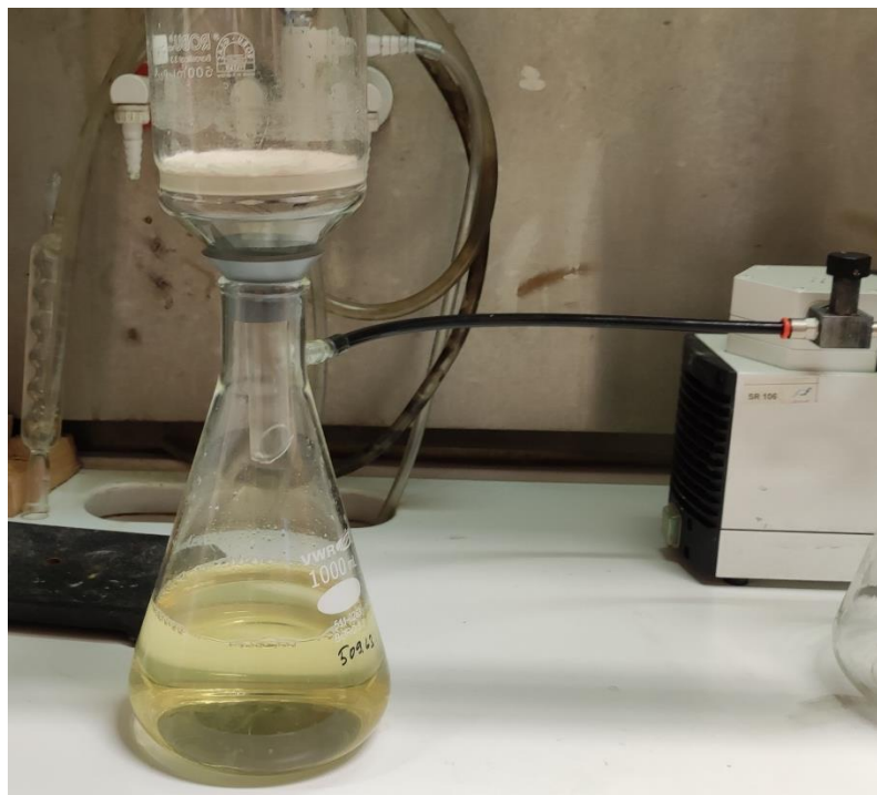
Joonis 11. A. niger 'i kultuuri filtreerimine klaasfiltriga.
