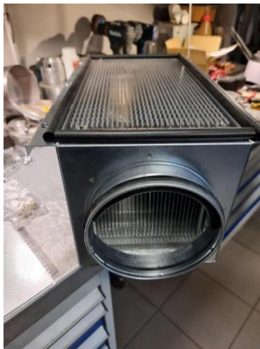
Joonis 7. Koroonalahendusel põhineva õhupuhastusseadme kollektor.
