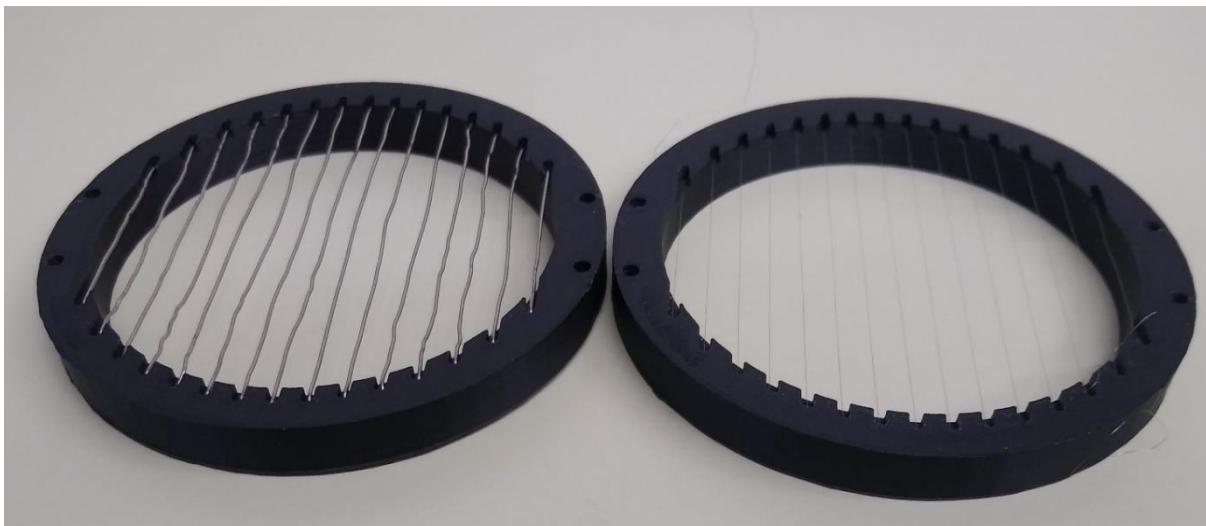
Joonis 9. Prototüübi II laaduri katoode (vasakul) ja anood (paremal).
