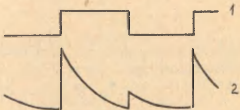
Рис. 43. Форма напряжения (1) и волны яркости (2) в случае возбуждения синусоидальным (а) и импульсным (б) полем.
