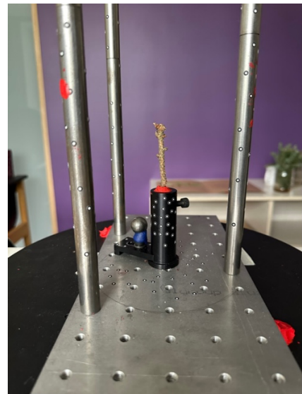
Joonis 9. Võrse roots (ilma okasteta) on kinnitatud plastiliiniga automatiseeritud pöördlaua külge ning on valmis skaneerimiseks
