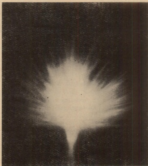
Рис. 3. Высокочастотная корона в воздухе при атмосферном давлении. d = 1,0\text{ mm} , L = 4,0\text{ cm} , \nu = 2,5\text{ MHz} .
