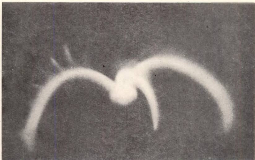
Рис. 5. Высокочастотная вспышка. d = 1,0 \text{ mm} , L = 4,0 \text{ cm} . \nu = 20 \text{ MHz} . U = 5,6 \text{ kV} , U_{\text{п}} = 0 .
