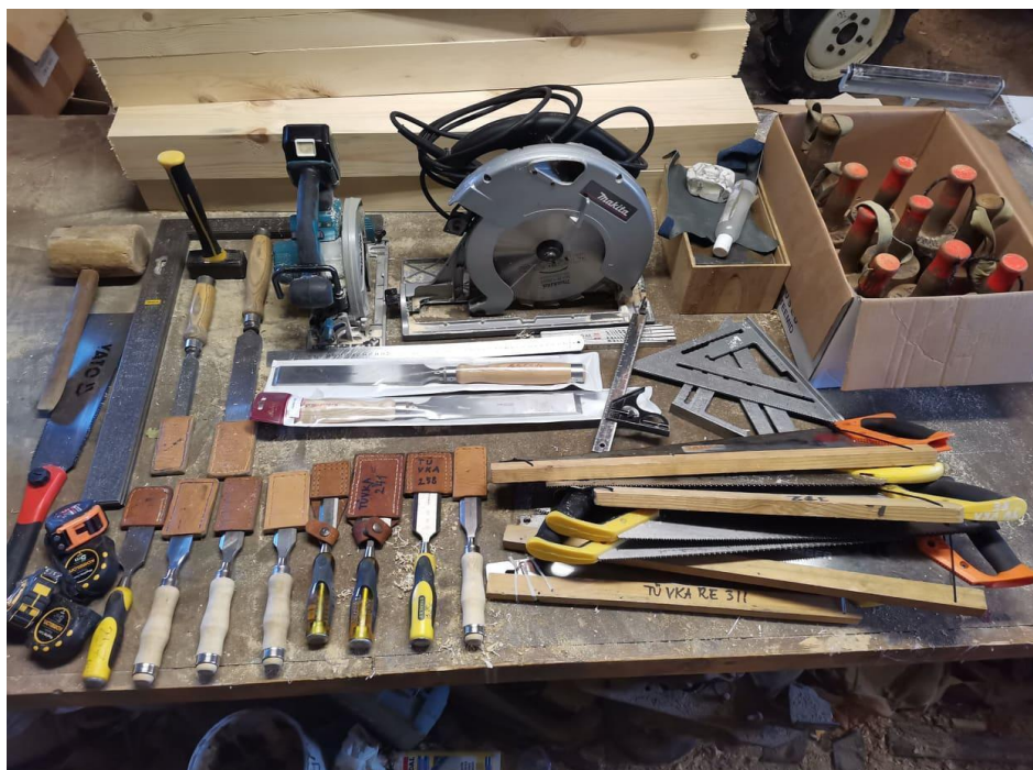
Joonis 28. Koolitusel kasutatud tööriistad. Lisaks oli veel mitu akuketassaagi ja Makita frees.
