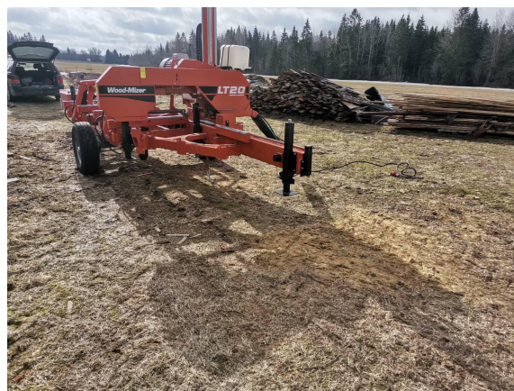
Joonis 25. Kasutatud saekaater Woodmeizer LT20.
