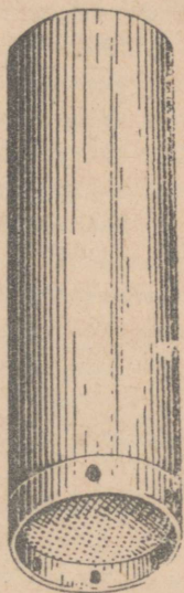
Joon. 3. Silinder liiva veemahutavuse määramiseks.
