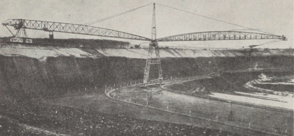
39. Ülal: Ühe kaevanduse hiiglaslik kaabelbager, raudkonstruktsiooni imesid, mis, arvestades tootuskihi tugevust ja katekihi vähest kõrgust, ehitati sildkaabelbagerina.
