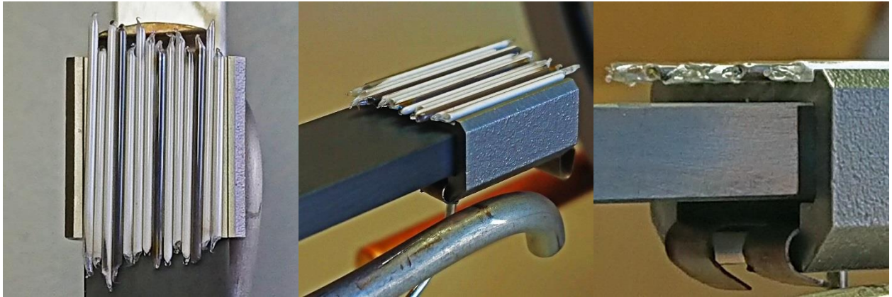
Joonis 3-14. Kapillaarid poolemillimeetrise süvisega proovihoidjal. Proovihoidja võimaldab pikemate kapillaaride kasutamist, kuna pole otstest tõkestatud. Kapillaaride mahaveeremise takistamiseks olevad küljed moodustavad ühtlasi justeerimiseks vajaliku piirpinna.
