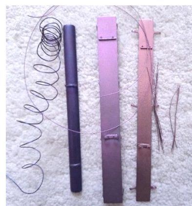
Joonis 20. Ehete titaandetailid peale anodeerimist.
