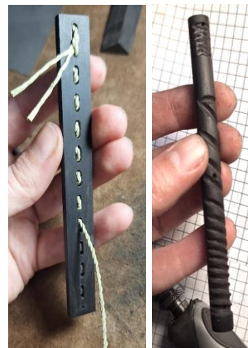
Joonis 19. Freesitud kanalid nõõride peitmiseks.
