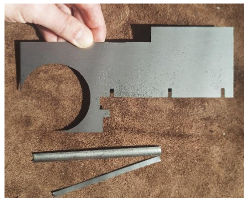
Joonis 7. Titaanplekk, millest on detailid välja lõigatud.
