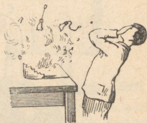
Joon. 31. Vesiniku ja õhu segu plahvatas klaasikeses. Õpilane süütas gaasi, kontrollimata vesiniku puhtust.
