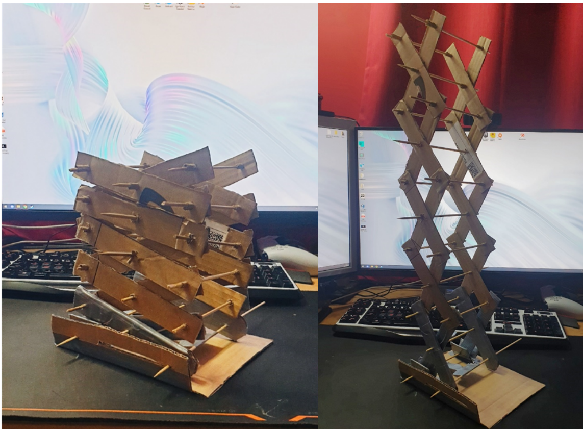
Joonis 4.1. Papp paberist valminud tõstemehhanism.
