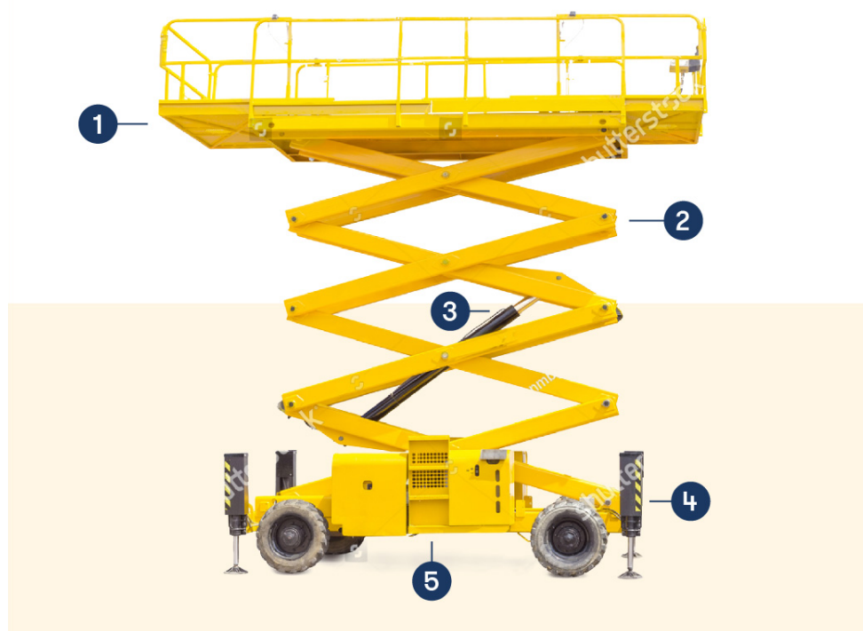
Joonis 2.8. Käärtõstuki osad ( 1. Platvorm; 2. Käärjalad; 3. Silinder; 4. Alus, 5. Toiteallikas)[21].
