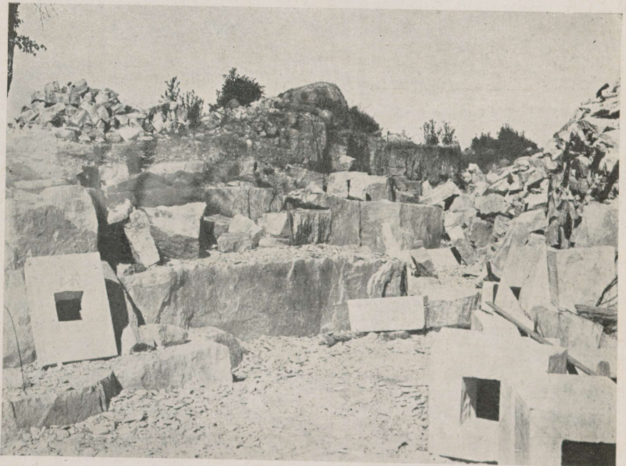
2. joonis. Kaarma lademe Kuigu paemurru vaade. Tähele panna dolomiitide paksu kihitust ja valmistatud korstnakive. Vt. III peat. Autori foto,
