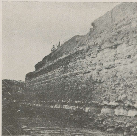
3. joonis. Põlevkivikihtide profiil pealmaakaevanduses Küttejõus. Tähele panna heledate lubjakivi- ja tumedate põlevkivikihtide vaheldust. Vt. IV peat., A. K. Orviku foto.
