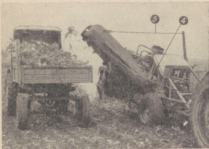
Joonis 2. Suhkrupedi laadimine traktori T-16 veokasti. 1 — tugi; 2 — tõmmits.
