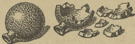
111. joon. Jääks muutudes paisub vesi tugevasti ja lõhub raudpommi.
