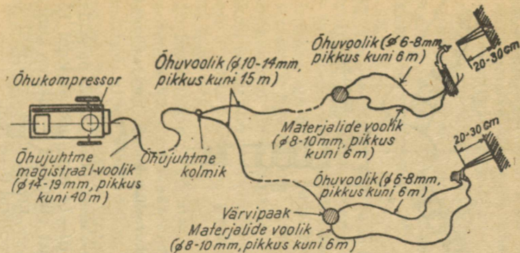
Joon. 17. Kahe üheaegselt töötava püstoli kompressor-agregaadi montaaž-skeem.
