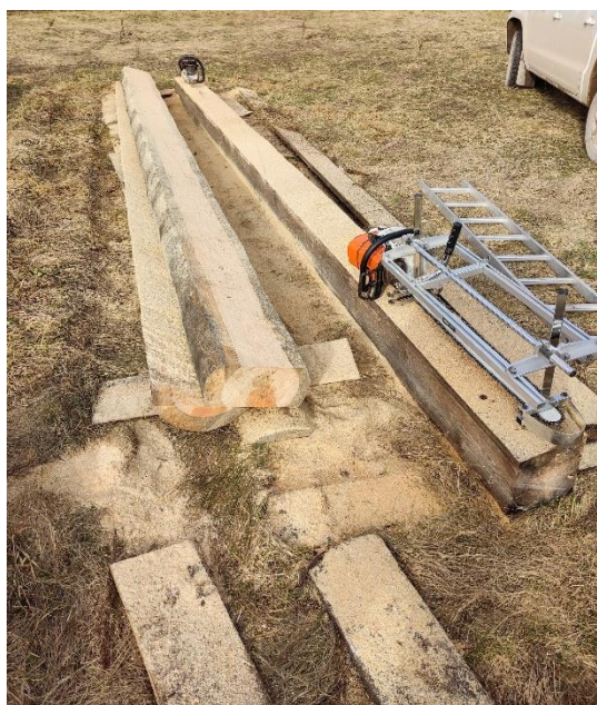
Joonis 13. Männi palgist prusside saagimine kettsaeraamiga (Joonis: J. Voll)
