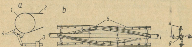
Joon. 115. Kummist kaabitsad transportööri lindi puhastamiseks a — kahekordse kaabitsa skeem; b — pöörlev kaabitsvõll; 1 — pöörlev trummel; 2 — lint; 3 — vastukaal; 4 — kummist äärised; 5 — kaabitsad; 6 — telg
