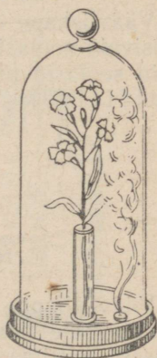
Joonis 53. Lillede valastamine väaveldioksüüdiga.
