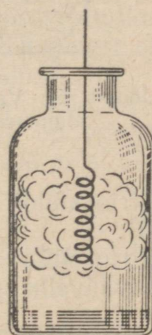
Joonis 55. \text{SO}_3 saamine \text{SO}_2 ja \text{O}_2 segust.
