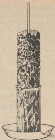
Joonis 58. Suhkru söestumine väävelhappes.
