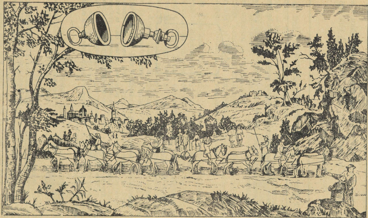
Joon. 104. Vanaaegne joonis Guericke katses. Joonise ülemises osas on kujutatud katses kasutatud poolkerad.
