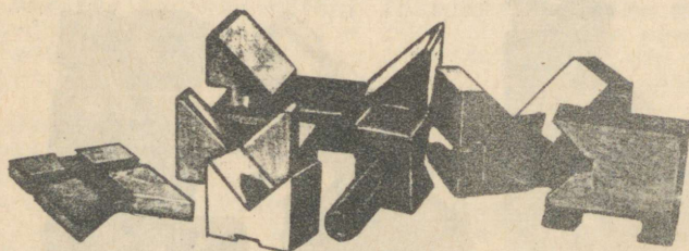
Joon.10 Prismad: vaheprisma ДСП-26/60x90x10, tugipris- ma ДСП-27, ДСП-28 ja tapiga prisma ДСП-29/18
