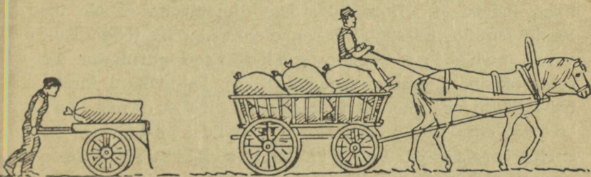
37. joon. Hobuse tõmbetugevuse mõõtmine koorma vedamisel.
