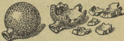
114. joon. Jääks muutudes paisub vesi tugevasti ja lõhub raudpommi.
