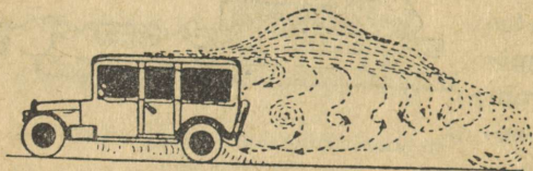
26. joon. Auto liikumisel tekkinud õhukeerised takistavad liikumist.
