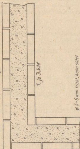
Seina nurga ladumine
