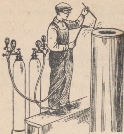
Joonis 14. Teraske keevitamine hapniku-atsetüleeni leegi abil.
