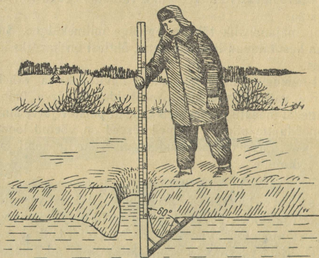
Joon. 118. Jäähäkke paksuse mõõtmine.
