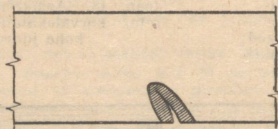
Joon. 21. Kuivamispragu servani väljaulatuvas oksakohas.
