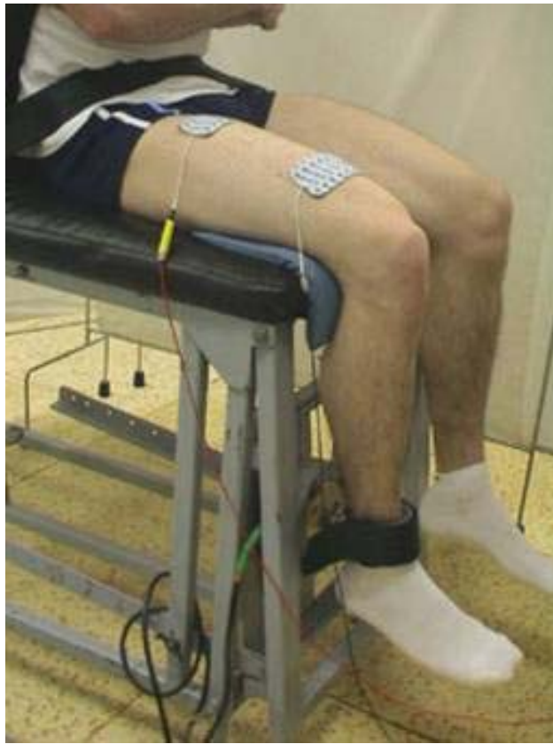
Joonis 1. Vaatlusaluse asend isomeetrisel dünamomeetrisel pingil.
