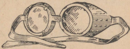
Joon. 133. Mitteküllunevast klaasist prillid, mis kaitsevad silmi kildude, sädemete ja sulametalli pritsmete eest.
