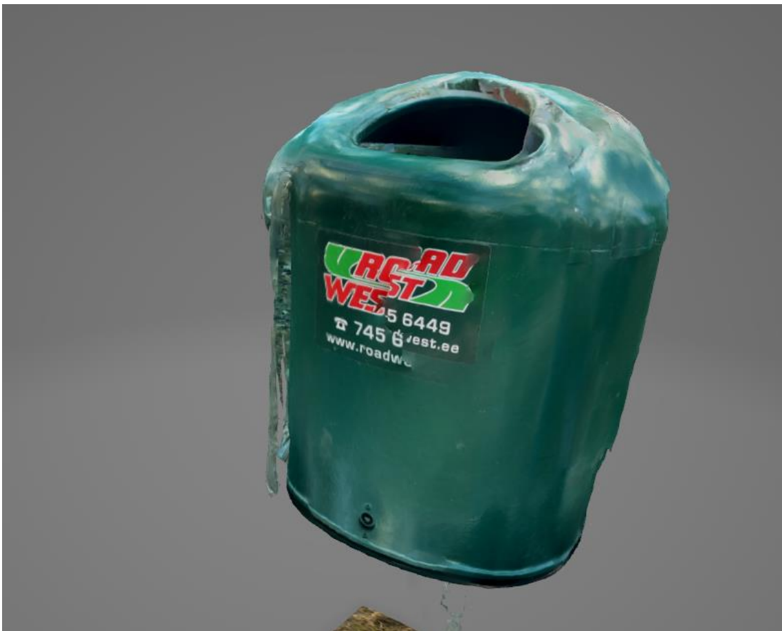
Joonis 15. Mudel, kus on sama koha uuesti skaneerimine teinud topelt-skaneeringu
