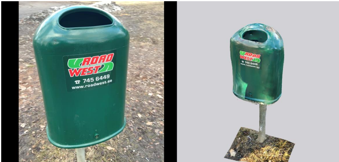
Joonis 6. Näide LiDARi probleemidest peegelduvate objektidega
