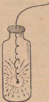
51. joonis. Terastraadi põlemine hapnikus.
