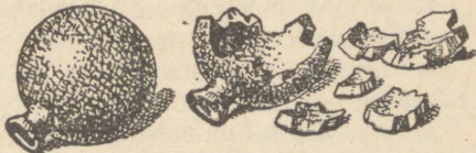
Joon. 114. Jääks muutudes paisub vesi tugevasti ja lõhub raudpommi.
