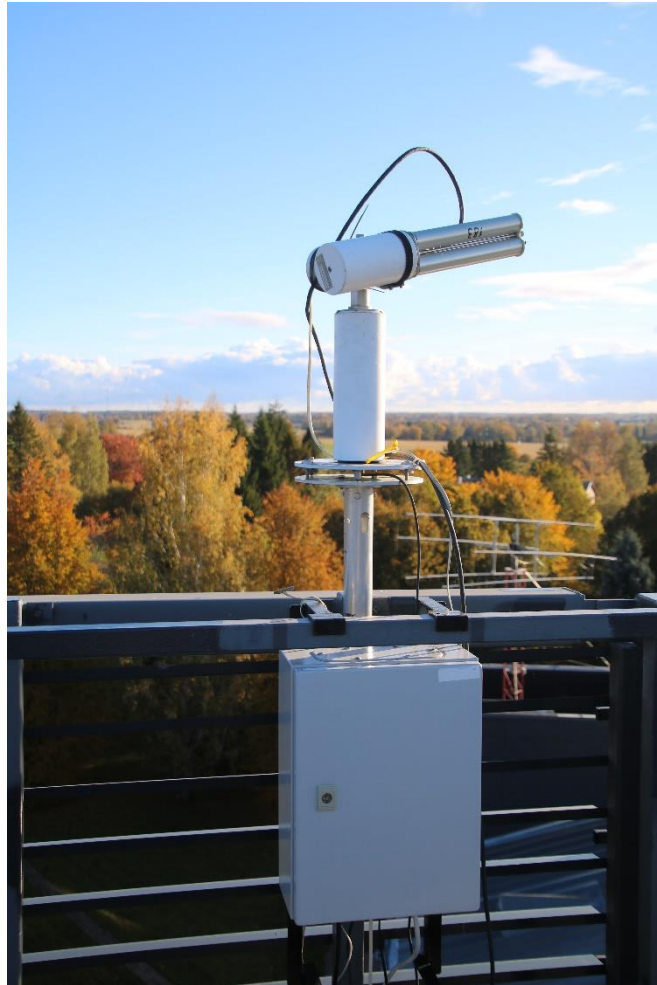
Joonis 4. CIMEL päikesefotomeeter Tartu Observatooriumi katusel.
