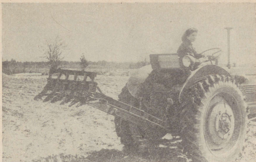
28. Kivitõugats traktorile MT3-2 («Belaruss») Vihula masina-traktorijaamas (Rakvere rajoon).
