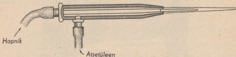
Joon. 22. Autogeenkeevitamisel kasutatav põletit.
