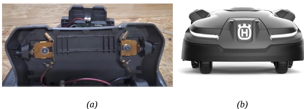
Joonis 2. (a) Husqvarna robotmuruniitja laadimisjaama laadimiskontaktid, (b) Husqvarna robotmuruniitja Automower 415x eestvaade laadimiskontaktidele.
