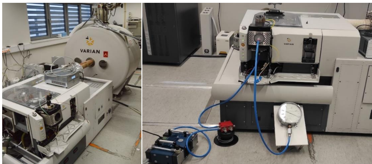
Joonis 8. Varian 910-FT-ICR-MS ja Varian J-320 (vasakul), APCI allikaga ühendatud vaakumpump laser-APCI-FT-ICR-MS katsete jaoks (paremal).
